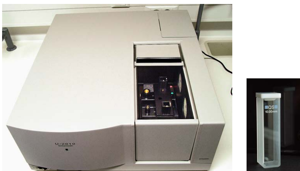
Figura 1.7. Espectrofotómetro UV-vis com o compartimento do porta-amostras aberto onde se pode ver a localização da amostra (à frente) e da referência (atrás). Ao lado uma cuvete de absorção com 10.00 mm de percurso óptico.
